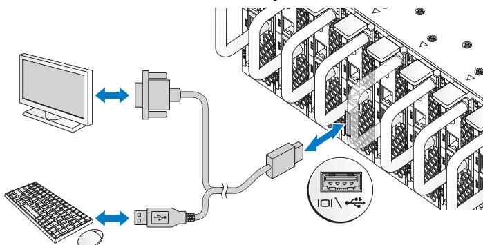
Der Anschluss an der Vorderseite des Systems ist mit einem Symbol gekennzeichnet, das angibt, welches Kabel einzustecken ist. Schließen Sie eine Tastatur, eine Maus oder einen Bildschirm an (optional).
