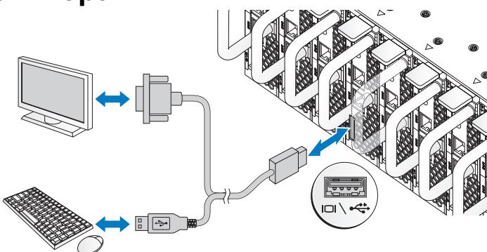
Разъемы на передней панели системы снабжены значками, позволяющими определить правильное подключение кабелей. Подключите клавиатуру, мышь и монитор (дополнительно).
