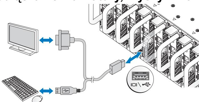
Złączka z przodu systemu ma ikonkę wskazującą, który kabel należy podłączyć. Podłącz klawiaturę, mysz lub monitor (opcjonalnie).
