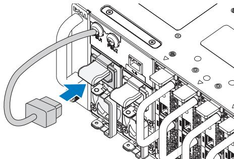
**ΣΗΜΕΙΩΣΗ:** Η σωστή διαμόρφωση των εσωτερικών καλωδίων τροφοδοσίας AC στο πλαίσιο στις υποδοχές PSU είναι αυτή που παρουσιάζεται στην παρακάτω εικόνα.
