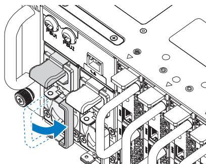
**3** Podłącz kabel zasilania obudowy do jednostki zasilacza.
