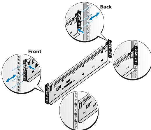
**3** Zopakováním kroků 1 až 2 usaďte a připevněte ke svislé přírubě přední konec kolejničky.
