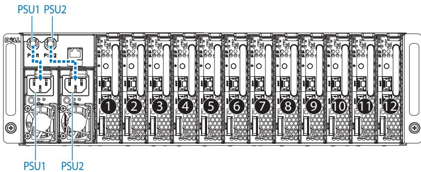
**4** Вставьте блок питания в систему так, чтобы закрылась защелка.
