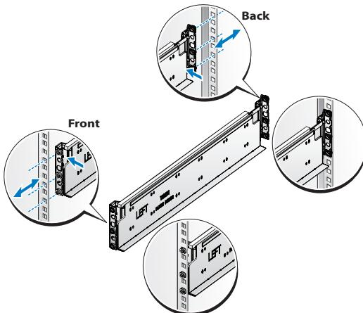
**3** Répétez les opérations 1 et 2 pour positionner et fixer l'embout avant sur la collerette verticale.
