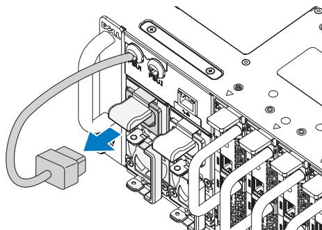
**2** Wyciągnij uchwyt jednostki zasilacza.
