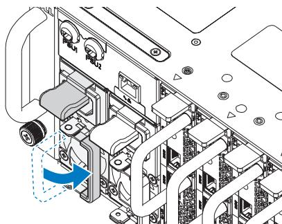
**3** Zapojte napájecí kabel šasi do jednotky zdroje napájení.
