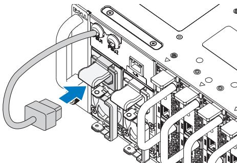
**POZNÁMKA:** Správná konfigurace integrálních napájecích kabelů šasi a soketů PSU je znázorněna na následující ilustraci.
