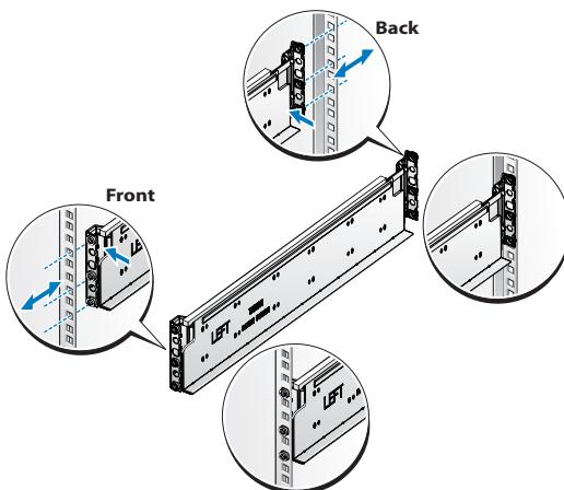
**3** Powtórz czynności 1 i 2 w celu umieszczenia i zamocowania przedniej końcówki na pionowej flanszy.
